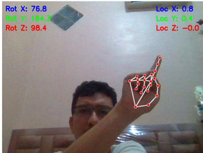
Gambar 3. Hasil deteksi landmark tangan, lokasi dan juga perhitungan rotasi dari ujung jari telunjuk
