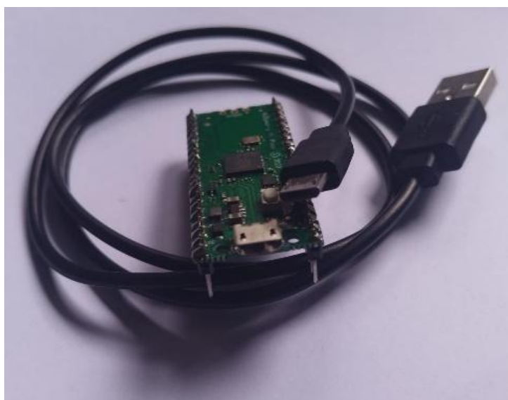
GAMBAR 2. PERANGKAT UTAMA BERUPA RASPBERRY DAN KABEL MICRO USB.
