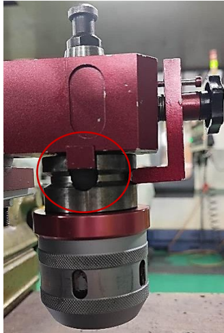
Gambar 4. Kondisi arbor stabil pada posisi 180° Sumber: Koleksi Pribadi
