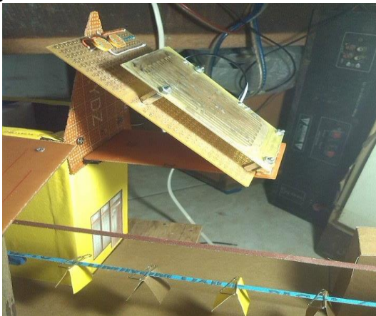
Gambar 8 Detail pemasangan sensor air dan LDR
