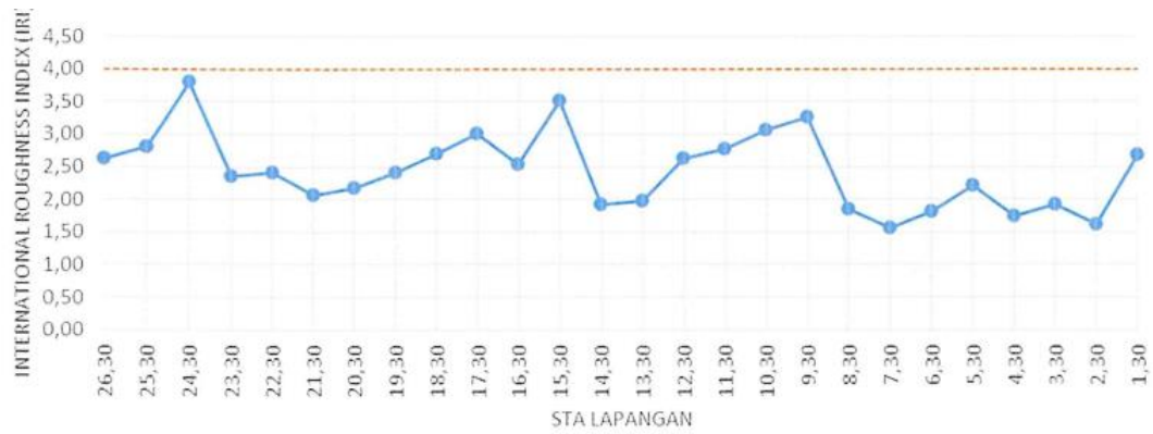
Gambar 4. Grafik Hasil Pengujian Indeks Ketidakrataan (Roughness) Ruas Jalan Tol Jakarta-Tangerang Pada Lajur 2
