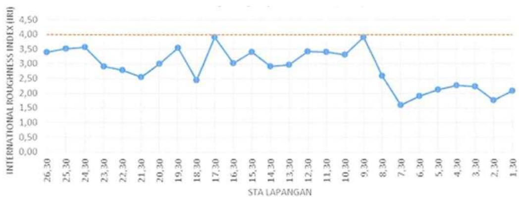
Gambar 3. Grafik Hasil Pengujian Indeks Ketidakrataan (Roughness) Ruas Jalan Tol Jakarta-Tangerang Pada Lajur 1 Sumber : PT. Jasamarga Tollroad Maintenance (2023)
