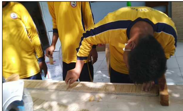
Gambar 2. Tahap Laminasi/Mengolesi Lem Epoxy (Sumber: Tim PkM UKDC, 2023)
