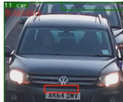
Gambar 33 Hasil deteksi plat nomor kendaraan
