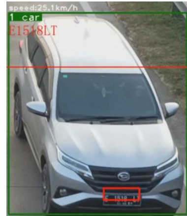
Gambar 32 Hasil deteksi plat nomor kendaraan
