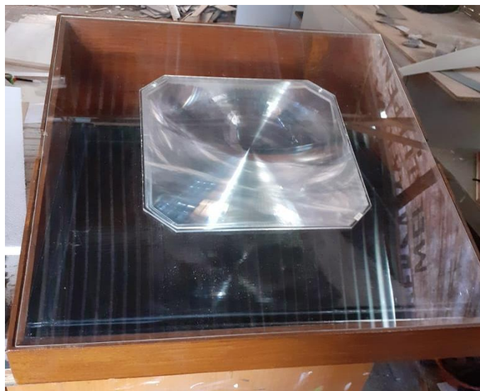
Gambar 2 Sistem Desalinasi menggunakan Lensa Fresnel
