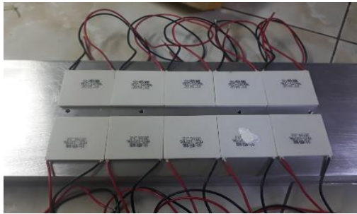
Gambar 5. Rangkaian implementasi 10 modul termoelektrik
