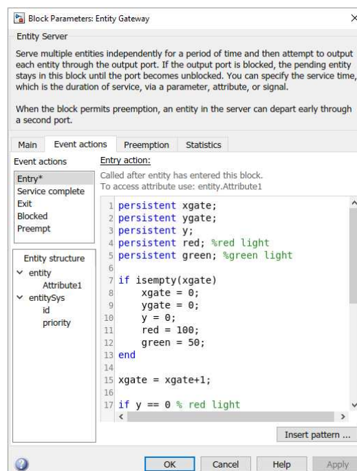
Gambar 4. Algoritma modul Gateway untuk durasi waktu lampu merah dan lampu hijau
