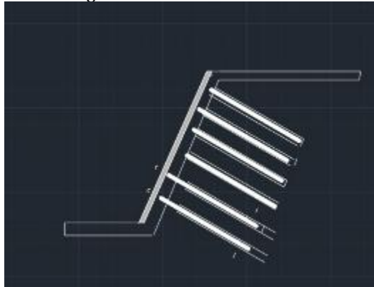
Gambar 4.24. Perencanaan Mitigasi Geoteknik Wiremesh dan Soil Nailing
