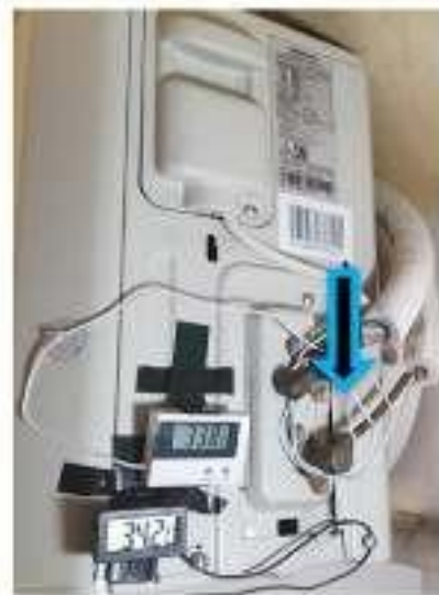
Gambar.4. Foto – foto Penempatan Titik Pungut/sensor Instrumentasi
