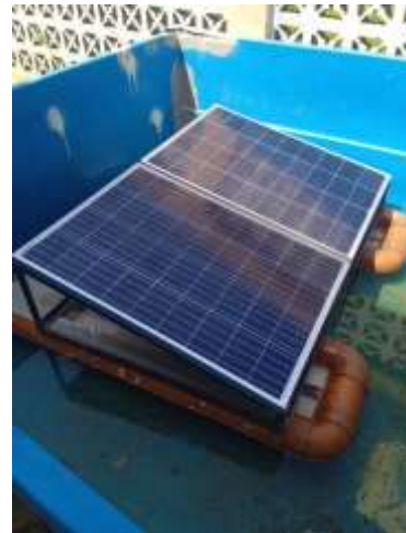
Gambar 7. Ujicoba PLTS terapung pada kolam uji
