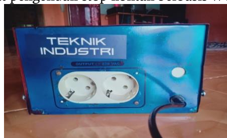
Gambar 5. Alat pengendali stop kontak berbasis Wemos D1
