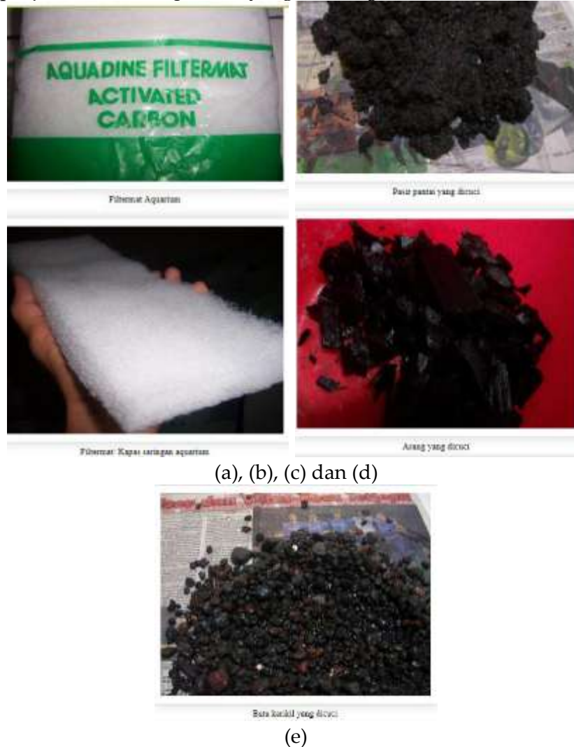
Gambar 2. (a), (b), (c), (d) dan (e) Bahan-bahan yang Digunakan untuk Filterisasi
