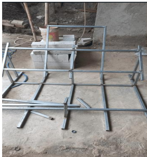
Gambar 3. Pembuatan Rangka Rice Transplanter
