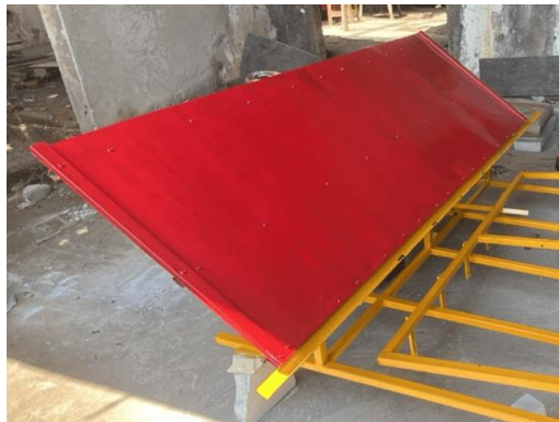
Gambar 4. Pembuatan Tray Rice Transplanter
