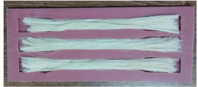
Gambar 4. Proses Pencetakan Spesimen ASTM D638
