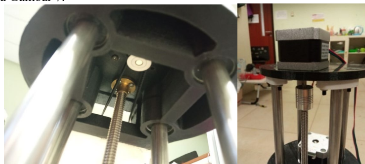
Gambar 7. Pasangan leadscrew M8 pada bagian Z axis mounting plate
