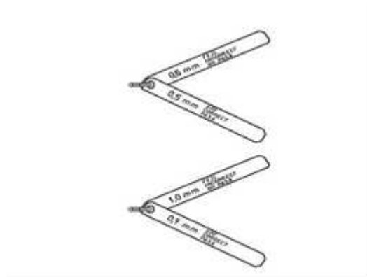
Gambar 2. Ukuran Velah Katup In dan Ex
