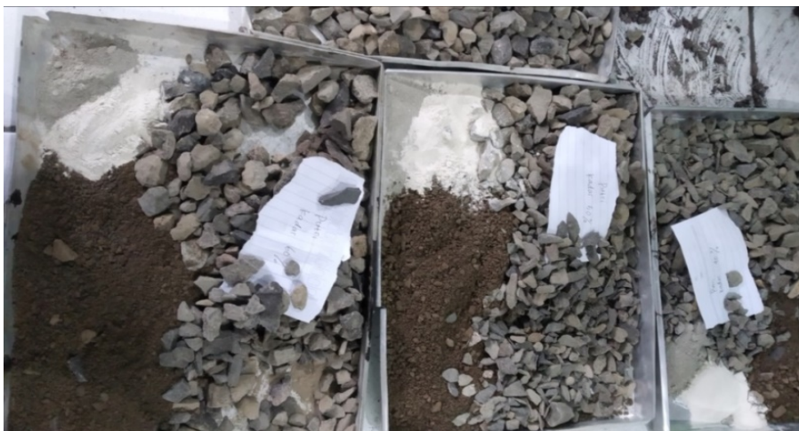
Gambar 2. Komposisi job mix aspal HRS-BC
