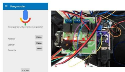
Gambar 16. Pengujian Sistem Starter Kendaraan
