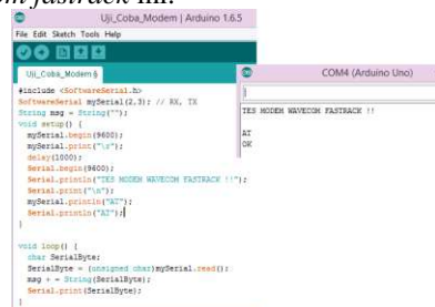
Gambar 8. Uji Coba Modem Wavecom
