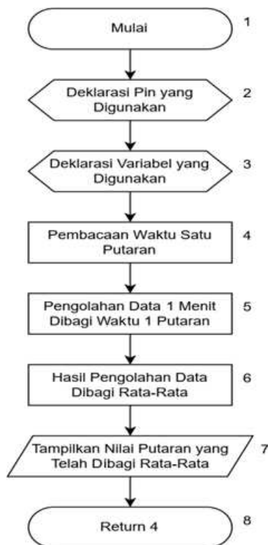
Gambar 6. Diagram Alir Sub Proses Pengolahan Data Sensor Kecepatan
