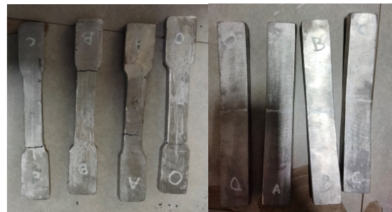
Gambar 9. Hasil pengujian tarik dan tekuk pada spesimen
