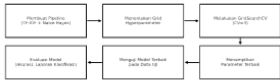
Gambar 2. Flowchart Pelatihan dan Pengujian Model Gambar 2 menunjukkan tahapan pelatihan mulai dari ekstraksi fitur TF-IDF, pelatihan model, hingga proses evaluasi performa dan penyimpanan model dalam bentuk file .pkl.
