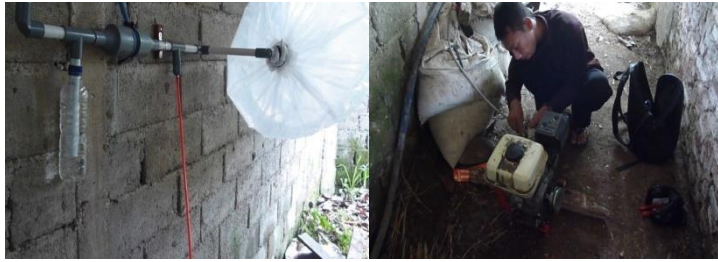
Gambar 6. Biogas sebagai Bahan Bakar Motor Bensin
