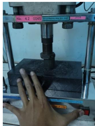
Gambar 5. Proses Uji Coba Pemangkas Flashing Pada Produk Seal Washer Menggunakan Pisau Pemangkas
