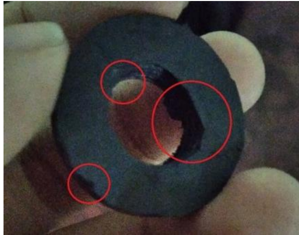
Gambar 8. Produk Seal Washer Setelah Dipangkas Manual Menggunakan Gunting
