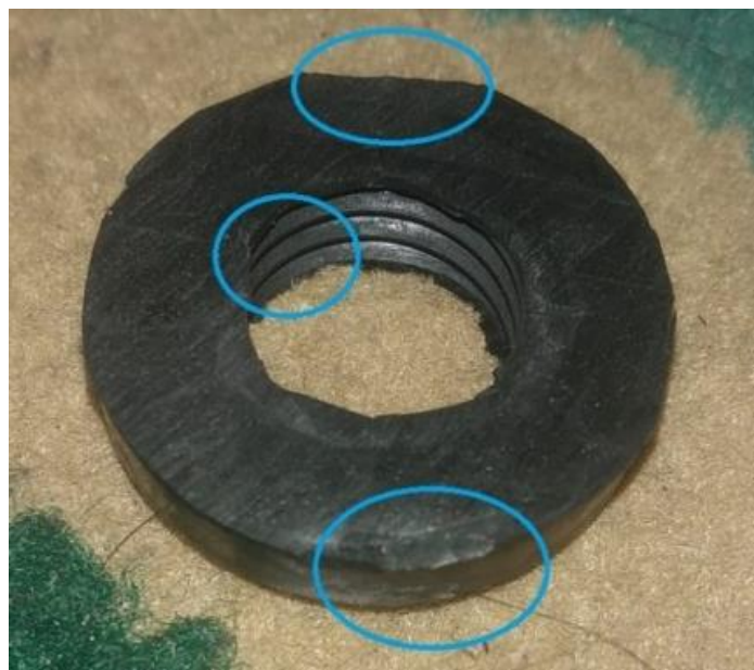
Gambar 1. Cacat Pada Produk Seal Washer
