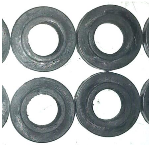
Gambar 7. Produk Seal Washer Setelah Dipangkas Menggunakan Pisau Pemangkas
