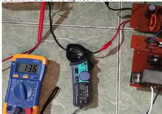
Gambar 3. Pengujian output dengan dummy load 10 \Omega , 480 Watt
