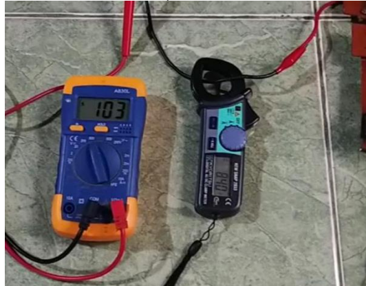
Gambar 2. Pengujian output dengan dummy load 10 \Omega , 400 Watt
