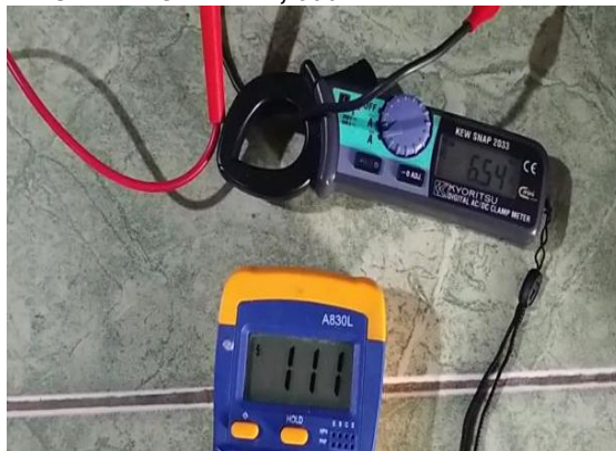
Gambar 6. Pengujian output dengan dummy load 11 \Omega , 500 Watt
