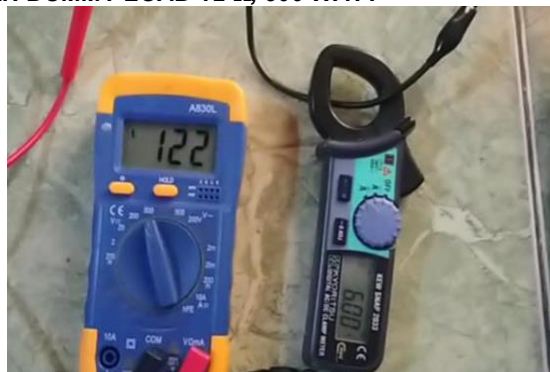
Gambar 4. Pengujian output dengan dummy load 12 \Omega , 500 Watt
