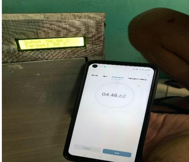
Gambar 8. Uji fungsi system sesudah mencapai target 50°C
