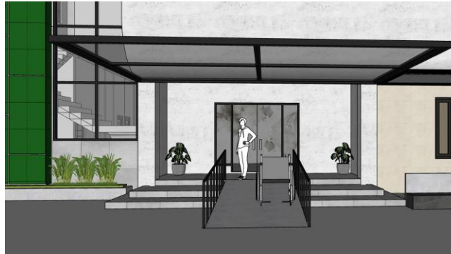
Gambar 8. Ramp pada pintu masuk utama
