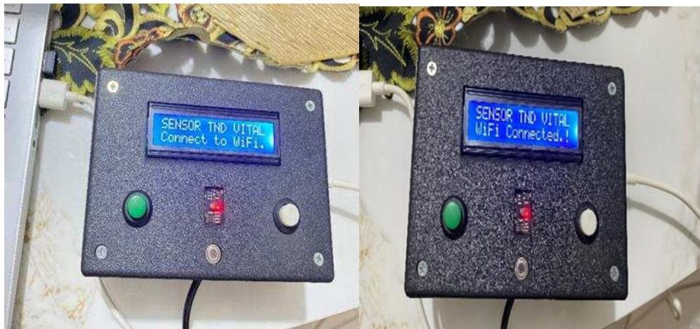
Gambar 6. Pengujian Mikrokontroler ESP32
