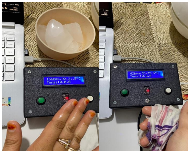
Gambar 8. Pengujian MLX90614 Pada Kondisi Suhu Tubuh Normal, Dingin, dan Panas
