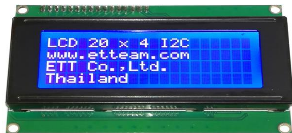
Gambar 2.5 Bentuk Fisik LCD 20x4
