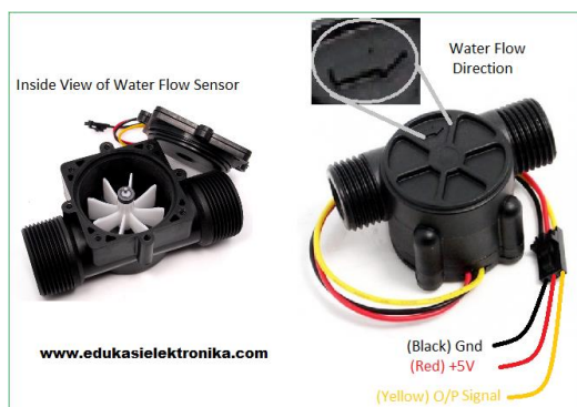
Gambar 2.3 Bentuk Fisik Sensor Water Flow YF S-201.
