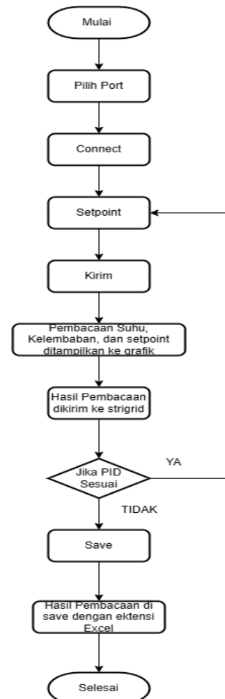
Gambar 6. Flowchart Diagram Aplikasi Monitoring oven menggunakan delphi 7
