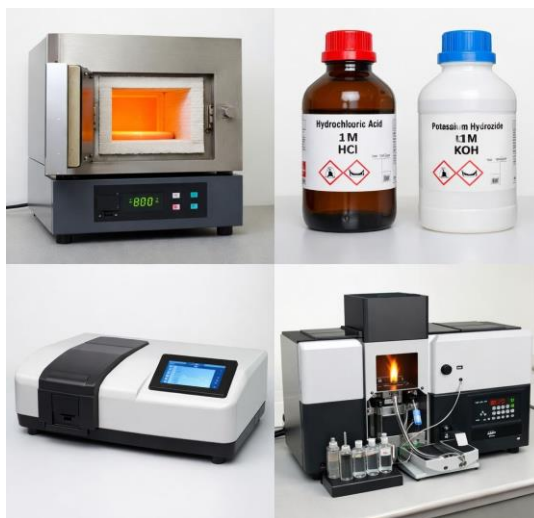
Gambar 1. Alat Karbonisasi (a), Bahan Aktivator (b), Alat Uji adsorpsi UV-VIS Spectrophotometer (c), dan alat analisis Logam Berat Atomic Absorption Spectroscopy (AAS) (d)
