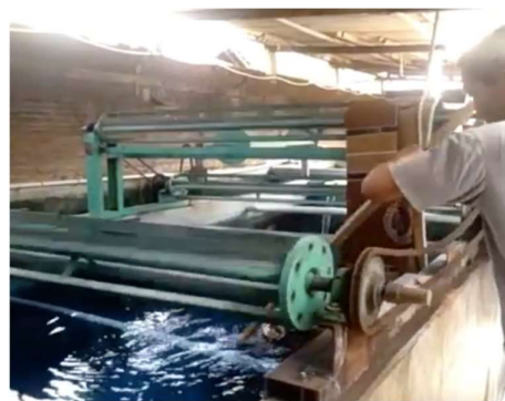
Gambar 5. Pembuatan mesin pencucian hasil pewarnaan.
