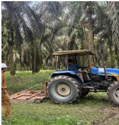
Gambar 11. Pengujian alat rotary slasher
