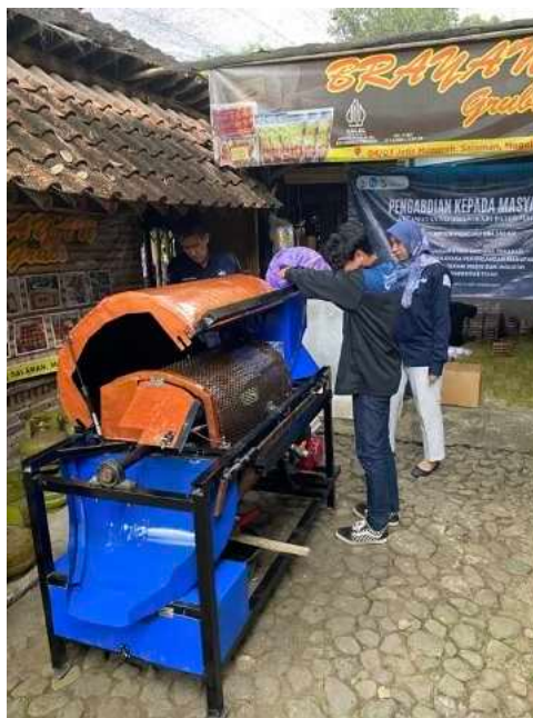
Gambar 9. Uji coba penggunaan mesin pencuci ubi jalar
