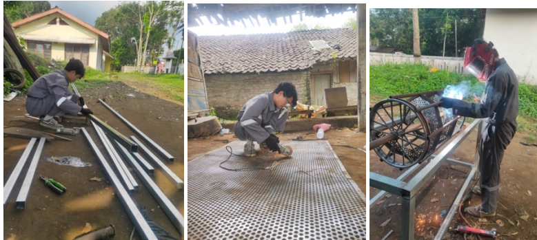
Gambar 5. Proses pembuatan mesin pencuci ubi jalar
