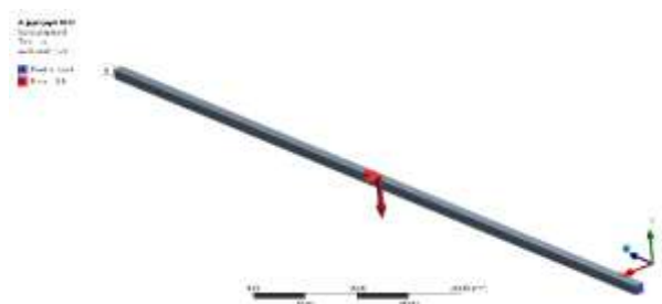
Gambar 7. Kondisi awal dan kondisi batas tumpuan jepit-jepit dan pembebanan 10 N
