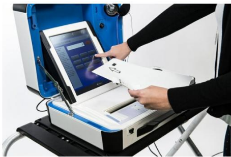
Gambar 4 Verityscan, perangkat untuk scan dan tabulasi suara dalam Pemilu.
