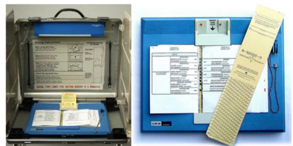
Gambar 3 Votomatic, mesin pemungutan suara yang menggunakan teknologi punch-card .
