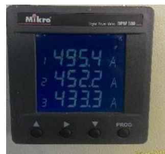
Gambar 14. Tampilan Alat Ukur untuk Nilai Arus per fasa tanggal 20 Juli 2016 pada Pukul 09:00 untuk Fasa I L1
