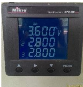
Gambar 11. Tampilan Alat Ukur untuk Nilai Harmonisa Arus dan Harmonisa Tegangan Tanggal 19 Juli 2016 pada 09:00 untuk Fasa L 3
