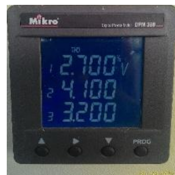
Gambar 12. Tampilan Alat Ukur untuk Nilai Harmonisa Arus dan Harmonisa Tegangan Tanggal 20 Juli 2016 pada Pukul 09:00 untuk Fasa L 3
