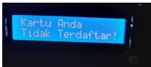
Gambar 7. Pengujian RFID Tidak Terdaftar
