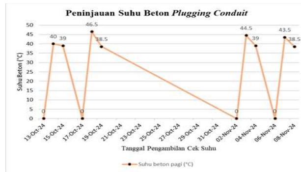
Gambar 5. Grafik Peninjauan Suhu Beton pada Pagi Hari di Area Plugging Conduit
