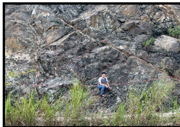
Gambar 4. Foto singkapan tingkat pelapukan III Bendungan Cisokan STA 4.
