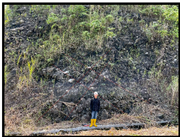
Gambar 5. Foto singkapan tingkat pelapukan IV Bendungan Cisokan STA 3.
