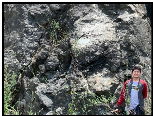
Gambar 2. Foto singkapan tingkat pelapukan I Bendungan Cisokan STA 1.
