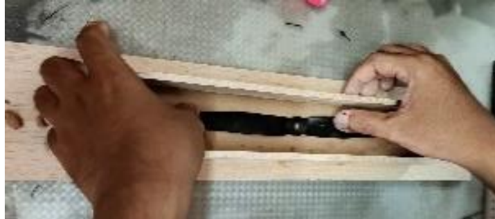
Gambar 5. Pembuatan master mold menggunakan tanah liat
