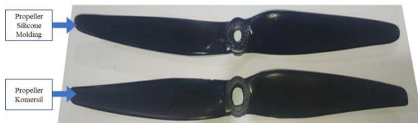
Gambar 15. Perbandingan propeler komersial dan hasil silicone molding
