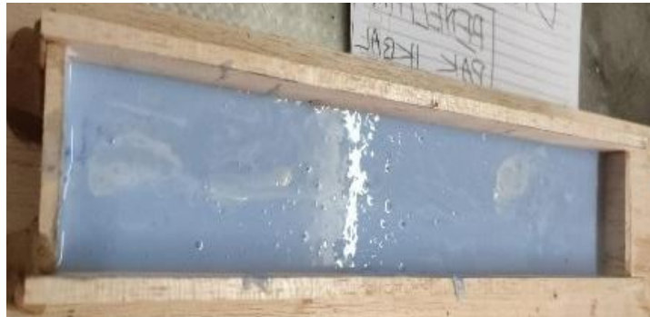
Gambar 6. Pengerasan campuran Silikon
