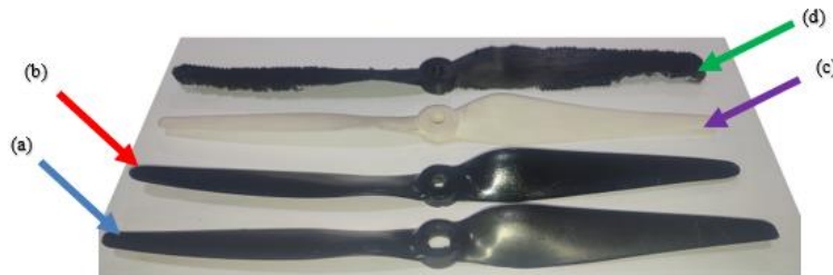
Gambar 14. Propeler acuan dan hasil manufaktur (a) Propeler komersial, (b) Propeler resin Silicone molding , (c) Propeler 3D printing modifikasi, dan (d) Propeler 3D printing non modifikasi
