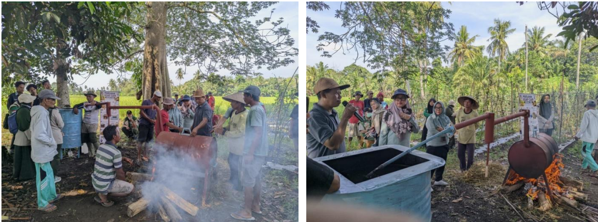
Gambar 5. Praktik pembuatan asap cair menggunakan alat pirolisis
