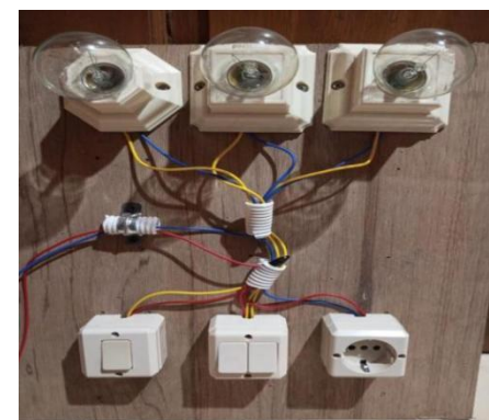
Gambar 5. Beban dari Rangkaian Alat Ukur
