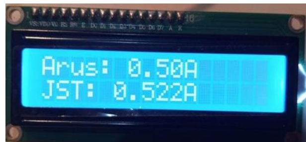
Gambar 13. Hasil pengukuran arus dengan JST
