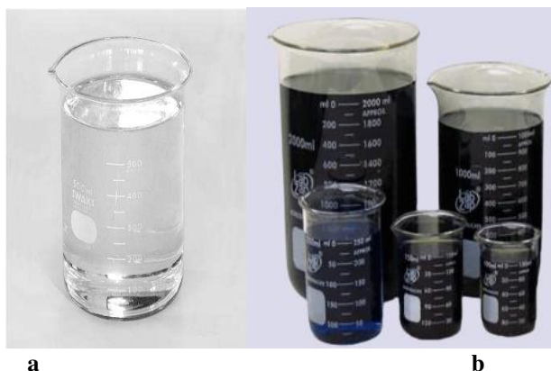
Gambar 7. (a) Hasil uji penggunaan koagulan hasil sintesis sebanyak 1 gram, (b) sebelum ditambahkan koagulan
