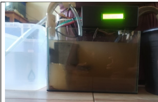
Gambar 3. Ujicoba Alat ,Ketika Mendeteksi Air kotor Mendeteksi Tinggi Batas Jarak Volume Air Yang Ditentukan dari Permukaan Sensor HC- SR04 Pada Akuarium
