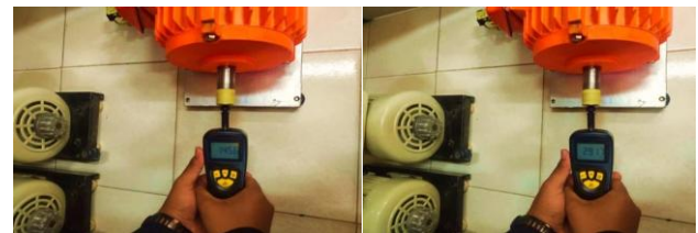
Gambar 3. pengukuran kecepatan rotor motor Dahlander
