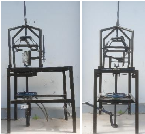
Gambar 2. Mesin pengupas kelapa yang digunakan
