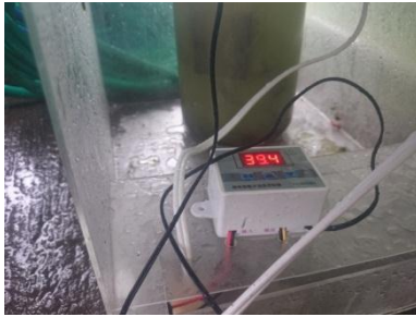
Gambar 11. Foto Percobaan Korosi Pada Larutan HCl Dengan suhu 40°C
