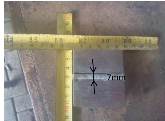
Gambar 4. Foto Hasil Pengelasan 120A.
